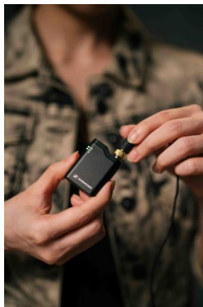
Die Ansteckmikrofone haben zusätzlich eine verschraubbare 3,5mm Klinkenbuchse zum Anschluss externer Lavalier-Mikrofone
